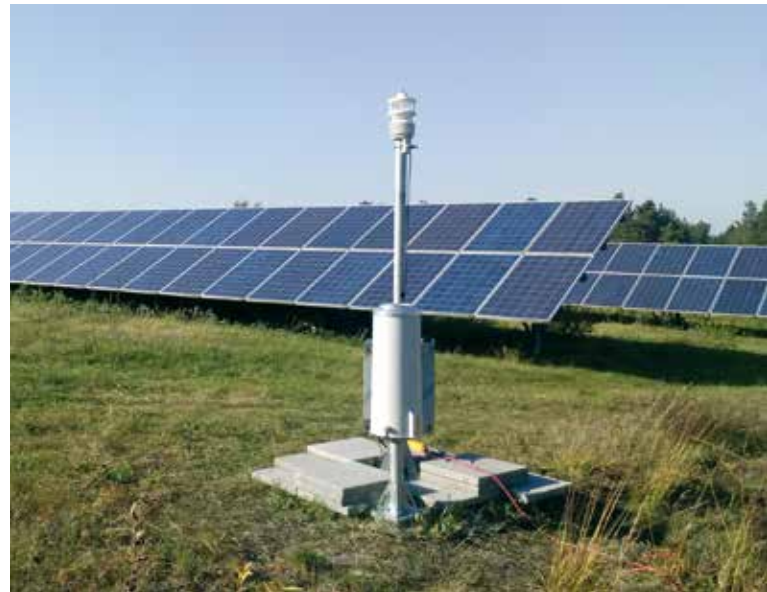
Klimastation der HTW Dresden auf der PV-FFA Anlage in Boxberg. Am Standort wird außerdem detailliert die räumliche Verteilung der Bodenfeuchte gemessen.
