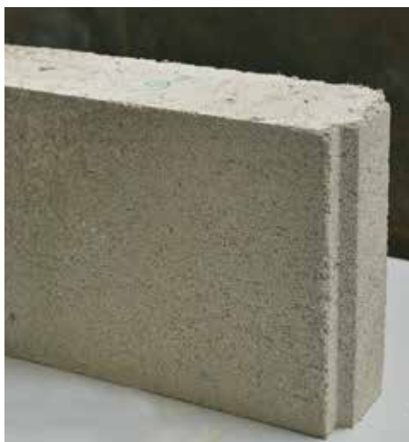
CFLC-Mauerstein im Format 10 DF (Herstellung im Rüttelpressverfahren)
