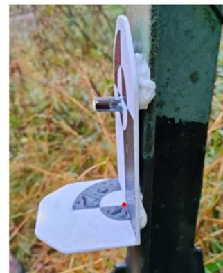
Abb. 2 Bolzen eines GVP, der mit einer Zieltafel zusätzlich für die Auswertung vermarktet wurde. Der in den Luftbildern abzusetzende Punkt ist rot eingefärbt.
