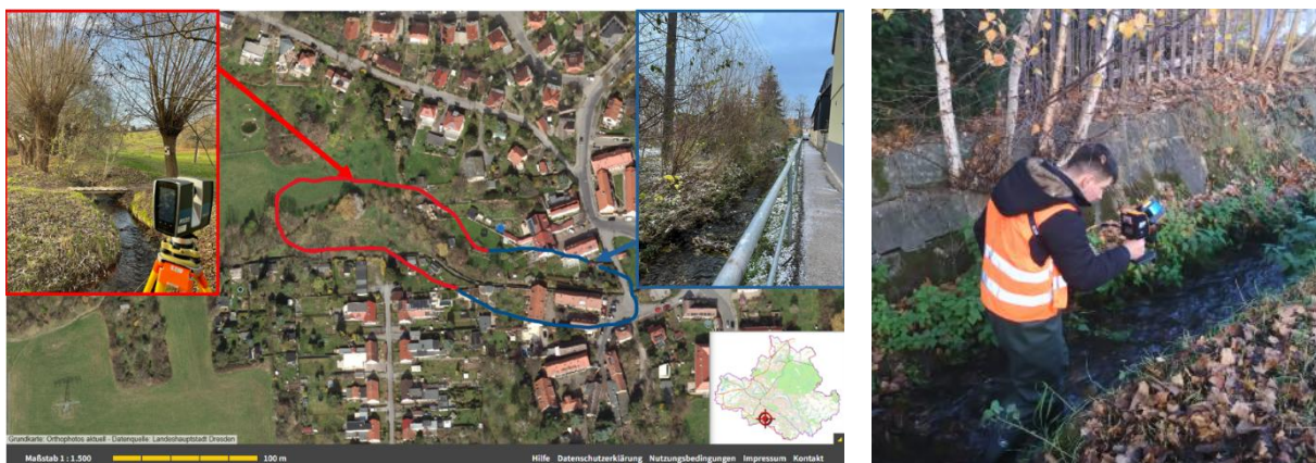
Abbildung 1: Untersuchungsgebiet und Aufnahme mit Zeb Horizon von GeoSLAM
