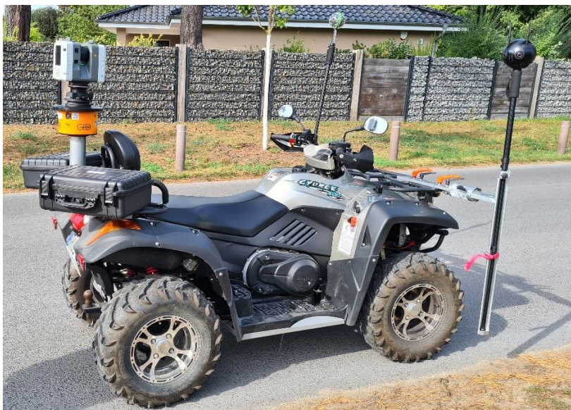
Abb. 1: MoveQuad mit Laserscanner und 360°-Kameras
