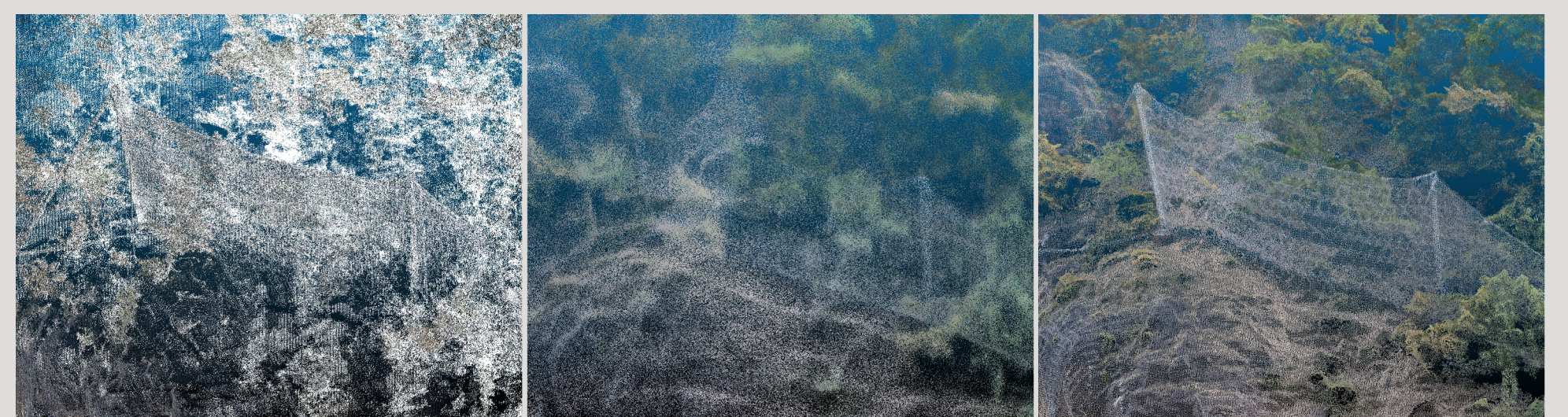
Visueller Vergleich der drei Punktwolken (TLS; ULS; UAV-Bildbasiert) an einem Steinschlagnetz
