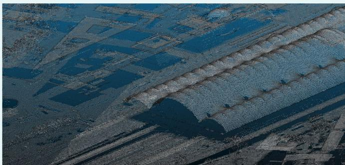
Abbildung 2: Schwebendes Bahnhofsdach mit Ball Pivoting in Open3D
