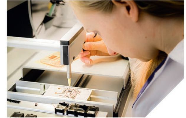
Bauelemente-Bestückung einer biobasierten Leiterplatte
